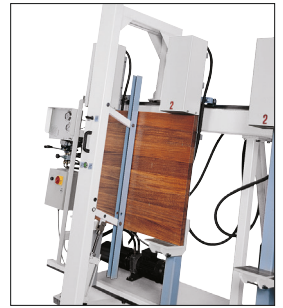
Particolare del pressore pneumatico azionato.
