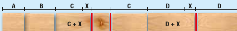
Taglio sequenziale con gestione segno / Coupe séquentielle avec gestion de marquage / Corte secuencial con marca
